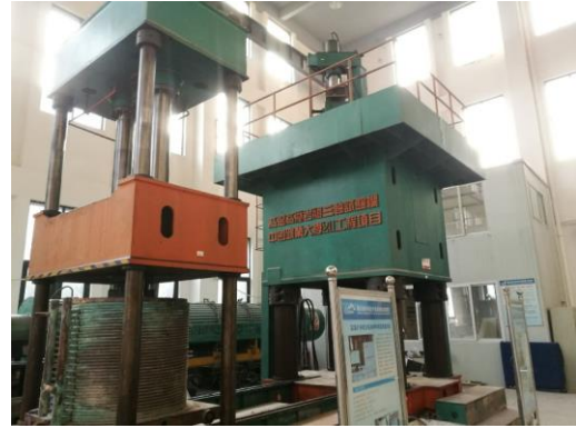
图 14 600°C 20MN 高温高压岩体三轴试验机
