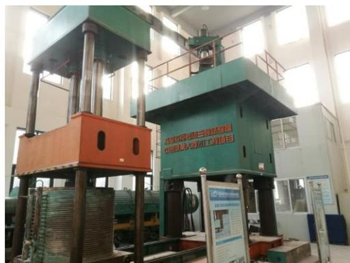
图 14 600°C 20MN 高温高压岩体三轴试验机
