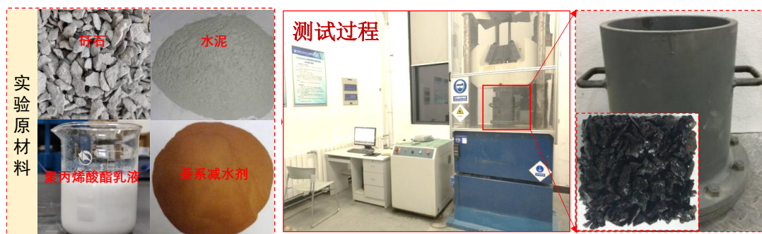
图 17 碎石基聚合物材料研制及承载压缩特性测试
