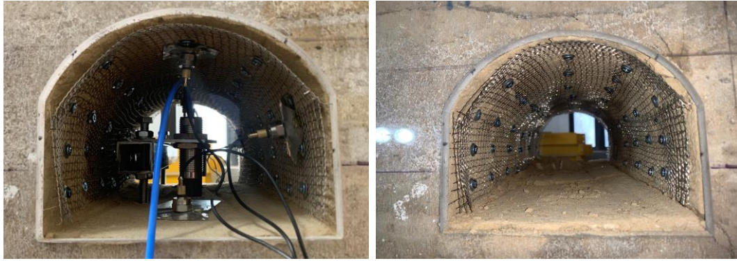
(a) 静载作用下巷道模型（0-200 mm）(b) 多次施加动载后巷道模型（0-200 mm）
