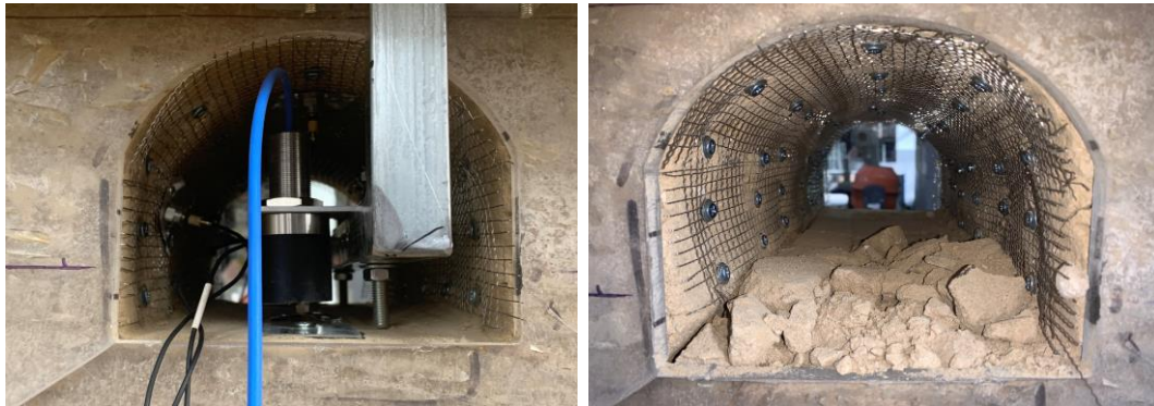
(c) 静载作用下巷道模型（200-400 mm）(d) 多次施加动载后巷道模型（200-400 mm）
